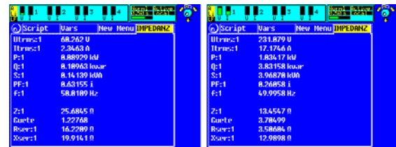
Bild 4: Anwenderdefiniertes Impedanz-Menü des Leistungsmessgerätes LMG500
